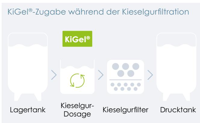
Der Einsatz von hochwirksamen **KiGel®**-Produkten reduziert die Dosage von Kieselgur um bis zu 30 %. Wir empfehlen bereits 30–50 g/m<sup>2</sup> Filterfläche bei der zweiten Voranschwemmung, damit das erste Bier direkt seine volle Stabilität erhält.
