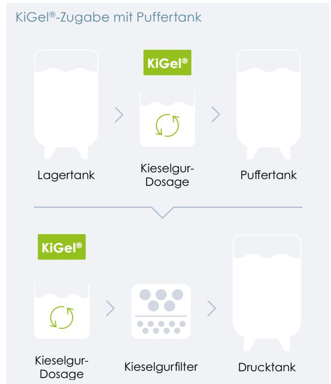
Wirkungsvoller ist die Dosage von **Beerzym® CHILL** in den Lagertank, da hier eine längere Kontaktzeit gewährleistet ist und die Aktivitäten des Produktes fast vollständig abgebaut werden. Die Restaktivität wird durch die Zugabe der **KiGel®**-Produkte während der Filtration adsorbiert. Bei der Verwendung von **Beerzym® CHILL** sind die jeweiligen Ländervorschriften (Reinheitsgebot) zu beachten.
