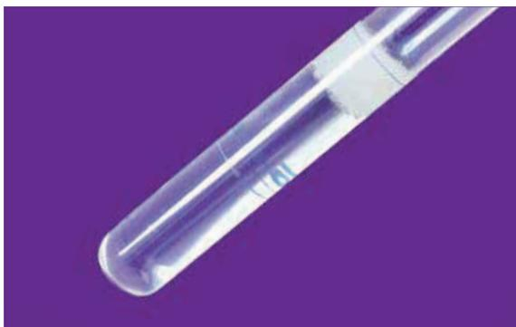
Image A : Test d'alcool pour la détermination de pectine restant dans le mût. La couche de gel flottante dans l'échantillon du mût montre que l'enzymage était insuffisant. Un enzymage supplémentaire de la flottation est nécessaire.
